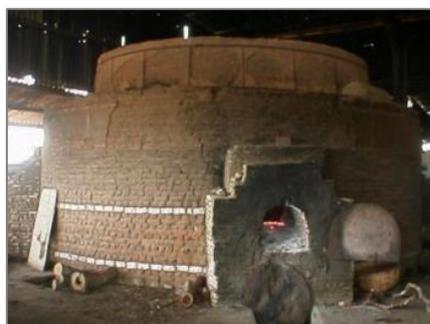
**Figura 11** – Forno tipo abóbada.
