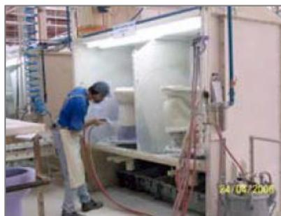
**Figura 21** – Louça sendo esmaltada por pulverização.
