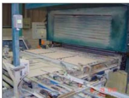
**Figura 19** – Entrada do secador vertical.
