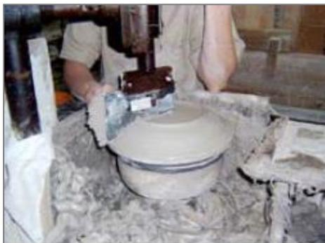
**Figura 18** – Peça cerâmica sendo torneada.
