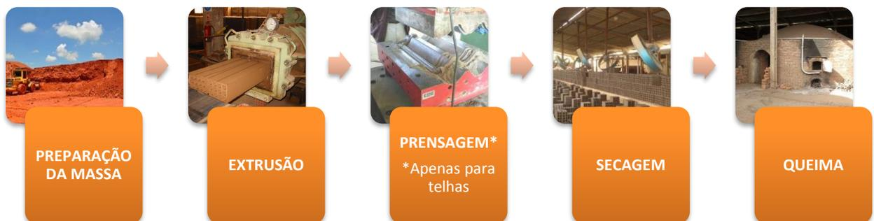
**Figura 25** – Macro etapas do processo de produção de cerâmica vermelha.
