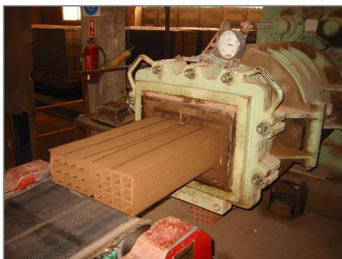
**Figura 6** – Maromba na fabricação de blocos.
