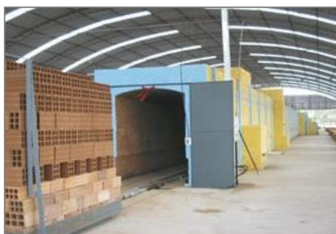
**Figura 15** – Forno tipo túnel.
