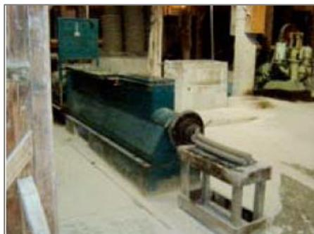
**Figura 17** – Material saindo da extrusora.
